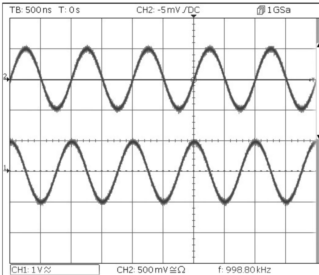
Se il canale 1 è impostato su 1MHz, anche il canale 2 è impostato su 1MHz.
