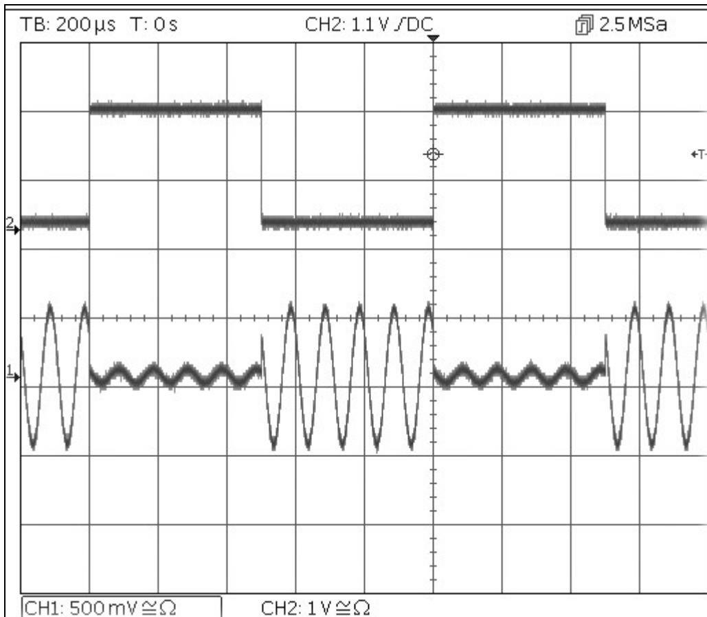
Notare che la seconda traccia è l'uscita dal socket principale dell'uscita 2 quando il canale 2 è sincronizzato, che segue il segnale di forma d'onda di modulazione.
