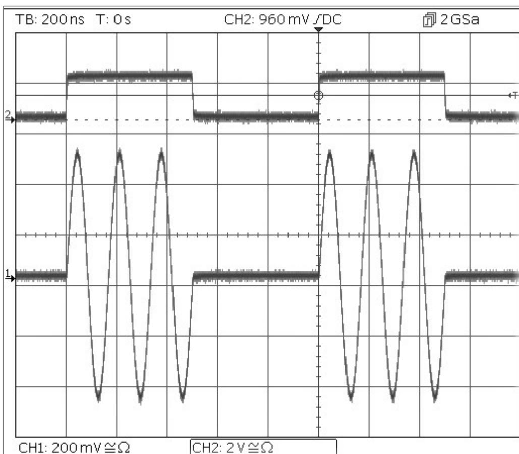
Beachten Sie, dass die zweite Messkurve das Ausgangssignal der Hauptbuchse von Ausgang 2 darstellt, wenn Kanal 2 synchronisiert ist und dem modulierenden Trigger-Eingangssignal folgt.
