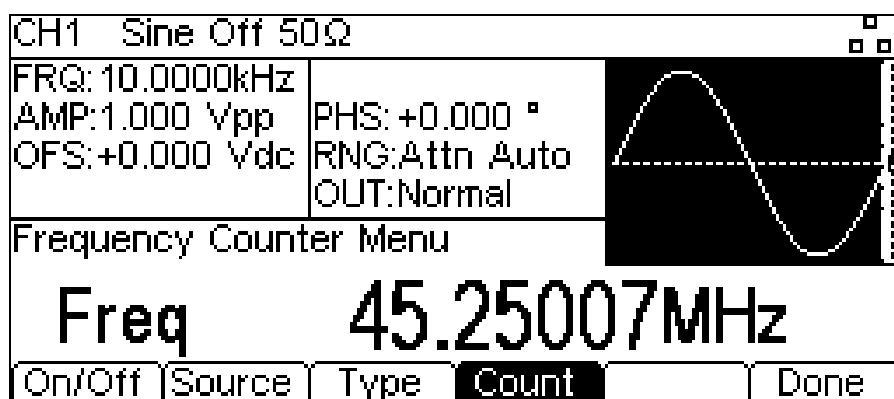
La fenêtre Modification affiche la mesure actuelle. Sans la présence d'un signal d'entrée à l'entrée sélectionnée, le compteur affiche « No signal » jusqu'à ce qu'un signal d'entrée adéquat soit appliqué.
