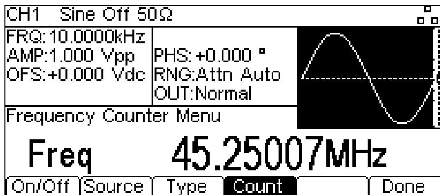
Der Editerbereich zeigt die aktuelle Messung. Wenn am ausgewählten Eingang kein Eingangssignal anliegt, zeigt der Zähler ‚No signal‘ an, bis ein entsprechendes Eingangssignal anliegt.
