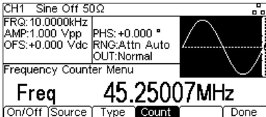
*La caja de edición muestra la medición actual. Cuando no existe ninguna señal presente en la entrada seleccionada, el contador indica No signal (sin señal) hasta que se aplique la señal adecuada.*
