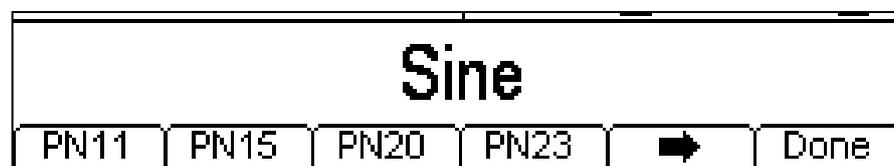
Una pulsación más de la tecla variable ➡ le mostrará de nuevo la primera lista. Seleccione la forma de modulación deseada pulsando la tecla correspondiente y luego pulse la tecla variable **Done** para volver al nivel principal del menú de modulación. Ahora ya están configurados todos los parámetros para PWM.
