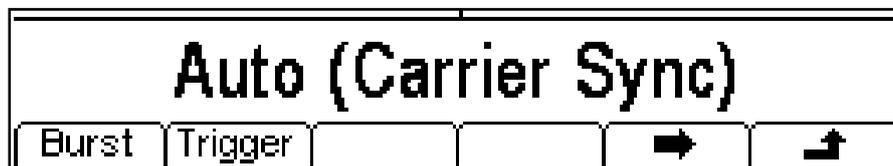
Una nueva pulsación de la tecla variable ➡ le mostrará de nuevo la primera lista. Elija el tipo de sincronismo deseado pulsando la tecla adecuada y luego pulse la tecla variable ⬆ para volver al nivel principal del menú Sync, o pulse la tecla UTILITY para salir de los menús de Utility.
