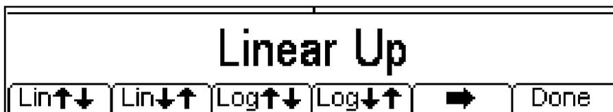
Una nueva pulsación de la tecla variable **→** le mostrará de nuevo la primera lista. Seleccione el tipo de barrido deseado pulsando la tecla correspondiente y luego pulse la tecla variable **Done** para volver al nivel principal del menú de barrido.
