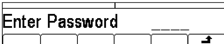
Cuando se introduce la contraseña correcta mediante el teclado, se muestra la pantalla inicial de la rutina de calibración, y se puede calibrar el aparato tal como se indica en el apartado «Rutina de calibración». Si se introduce una contraseña incorrecta, el mensaje **Incorrect Password Please Try Again** (contraseña incorrecta, inténtelo de nuevo) aparecerá durante dos segundos antes de que la pantalla regrese al menú Utility.
