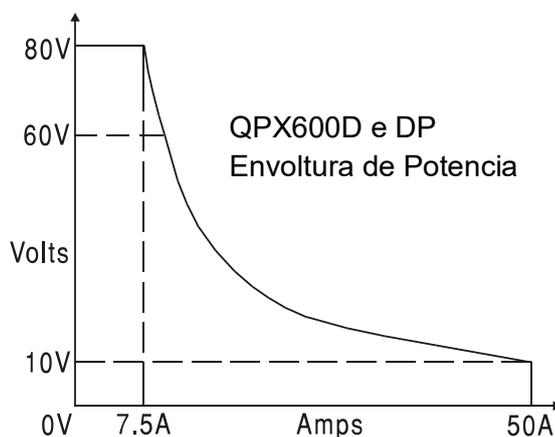
Il power envelope è impostato in modo da erogare 80V / 7.5A e 10V / 50A a qualsiasi condizione di alimentazione (entrambe le uscite sotto carico); a tensioni erogate inferiori, la potenza erogata è limitata alla corrente massima di 50A.
