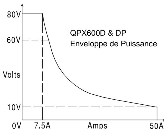
L'enveloppe de puissance est réglée pour donner 80 V/7.5 A et 10 V/50 A lorsque toutes les conditions d'alimentation sont remplies (les deux sorties sont chargées) ; lorsque les tensions de sortie sont inférieures, l'intensité maximum de 50 A limite la puissance de sortie.
