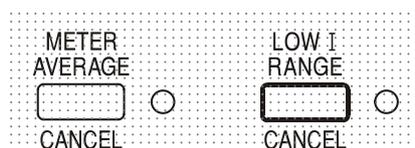
La limite supérieure de la commande CURRENT peut alterner entre le maximum pour ce modèle et 75mA avec des pressions alternatives sur la touche LOW I RANGE afin d'affiner le réglage de la limite de courant et de la résolution de mesure (de 0,01mA à 75mA) ; l'indicateur placé à côté de la touche s'allume lorsque le bas de gamme est sélectionnée.
