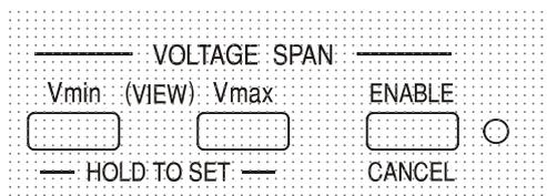
V-Span est activé ou désactivé à l'aide de la touche ENABLE. L'indicateur ENABLE est allumé lorsque V-Span est sélectionné. La valeur d'usine par défaut est  $V_{min} = 3V$ ,  $V_{max} = 5V$
