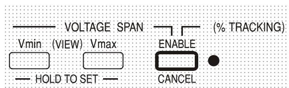
Le Ratio Tracking est activé par une pression sur la touche ENABLE dans la section VOLTAGE SPAN du Slave (indicateur ENABLE activé)
