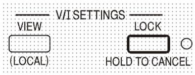
Si la sortie est toujours activée, le message **OP on** (sortie activée) clignote deux fois à l'écran, suivi par le clignotement des nouveaux paramètres « non verrouillés » pendant 2 à 3 secondes (un clignotement lent, puis plus rapide), avant que le changement ne soit finalement appliqué, l'indicateur LOCK s'éteint une fois le changement effectué.
