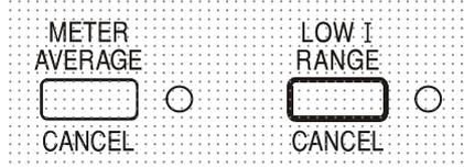
La limite supérieure de la commande CURRENT peut alterner entre le maximum pour le modèle et 500 mA (800 mA pour la sortie 6 V) avec des pressions alternatives sur la touche Low I RANGE afin d'affiner le réglage de la limite de courant et de la résolution de mesure (de 0,1 mA à 500 mA/ 800 mA) ; l'indicateur placé à côté de la touche s'allume lorsque la plage Low I est sélectionnée.
