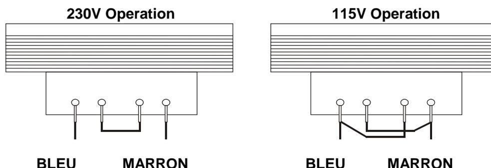
4. Remontez l'appareil dans l'ordre inverse. Pour se conformer aux prescriptions des normes de sécurité, la tension d'alimentation indiquée sur le panneau arrière doit être modifiée pour indiquer clairement le nouveau réglage de tension.
