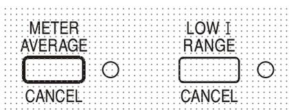
Pour réduire les sautilllements avec des courants de charge variant rapidement, il est possible de sélectionner une constante d'une durée de 2 secondes en appuyant sur la touche METER AVERAGE ; l'indicateur situé à côté de la touche s'allume lorsque la moyenne du mètre est sélectionnée.
