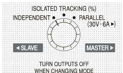
Les quatre modes de fonctionnement des sorties 30 V du Quad-Mode Dual et Triple sont décrits ci-dessous ; on modifie ce mode à l'aide de la molette MODE. Pour éviter l'application accidentelle de tensions imprévues aux circuits connectés aux sorties, le changement de mode provoque toujours une désactivation des deux sorties.
