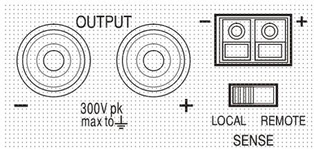
Ce problème peut être minimisé en utilisant des fils de raccordement courts et épais, mais lorsque cela s'avère nécessaire, on peut le surmonter complètement en utilisant la fonction de détection à distance. Ceci nécessite de connecter les bornes de détection à la sortie sur la charge plutôt que sur la source ; insérer les fils dans les bornes à ressort SENSE (détection) et les connecter directement à la charge. Basculez le commutateur LOCAL/REMOTE sur REMOTE.
