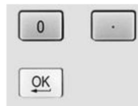
È possibile inserire volt o ampere a una risoluzione di 0,001 volt e 0,001 ampere per le uscite 1 e 2 e 0,01 volt e 0,01 ampere per l'uscita 3.
