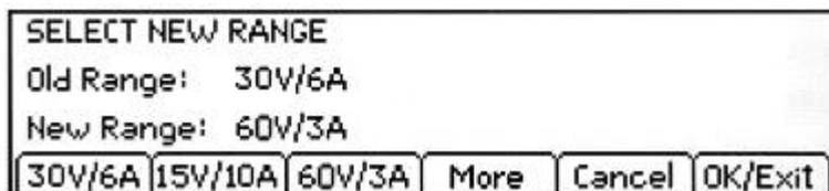
Per l'uscita 1, i quattro intervalli aggiuntivi vengono selezionati premendo il tasto More (Altro). Solo per l'intervallo da 120 V viene mostrato un simbolo del fulmine lampeggiante per l'alta tensione quando viene impostata una tensione superiore a 60 V.
