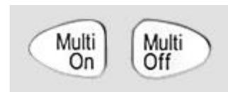
Mit der Systemmenü-Funktion „Multi-On/Multi-Off Setup“ kann die Funktion dieser Tasten den Anforderungen des Anwenders angepasst werden. So kann z. B. eine Verzögerung zwischen dem Schalten der Ausgänge eingerichtet werden, um eine On oder Off Sequenz zu bilden, oder es kann ein einzelner Ausgang von der Multi-On / Multi-Off Funktion ausgeschlossen werden.
