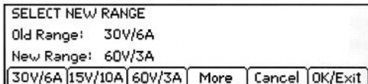
Für Ausgang 1 werden die vier zusätzliche Bereiche durch Drücken der Taste „More“ ausgewählt. Im 120V-Bereich wird ein blinkendes Hochspannungssymbol angezeigt, wenn eine Spannung über 60V eingestellt ist.
