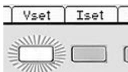
Mit Ausnahme der On/Off Tasten für die Ausgänge erfolgt die primäre Steuerung der Stromversorgung über die sechs Tasten direkt unter dem Display. Diese werden als „Softkeys“ bezeichnet, da ihre Funktion nicht festgelegt ist, sondern durch eine Textzeile auf der Anzeige direkt darüber angezeigt wird.
