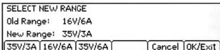
Beachten Sie, dass eine Bereichsänderung nur erfolgen kann, wenn der Ausgang ausgeschaltet ist. Wenn der Ausgang eingeschaltet ist, wird der Benutzer aufgefordert, diesen auszuschalten.
