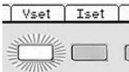
Mit Ausnahme der On/Off Tasten für die Ausgänge erfolgt die primäre Steuerung der Stromversorgung über die sechs Tasten direkt unter dem Display. Diese werden als „Softkeys“ bezeichnet, da ihre Funktion nicht festgelegt ist, sondern durch eine Textzeile auf der Anzeige direkt darüber angezeigt wird.
