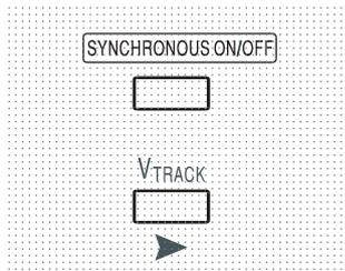
La tecla SYNCHRONOUS ON/OFF (encendido/apagado sincronizado) es una opción adicional a los interruptores OUTPUT individuales, permitiendo conectar o desconectar ambas salidas simultáneamente con una sola pulsación. Puesto que esta tecla enciende o apaga las dos salidas con pulsaciones alternas, es necesario que ambas se encuentren en el mismo estado (encendidas o apagadas) para poder usarla.
