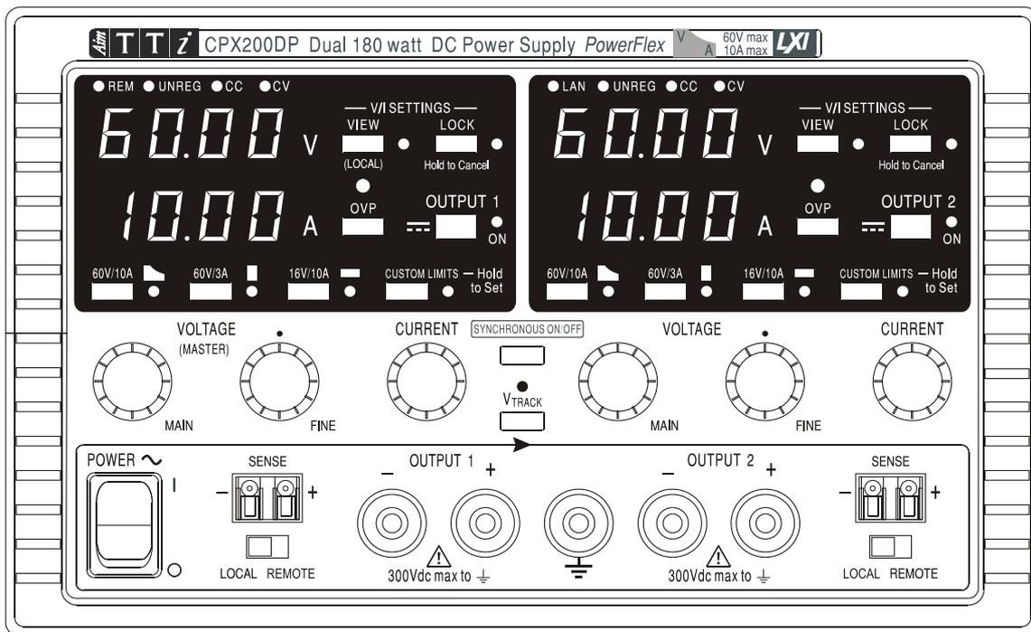
La carga debe conectarse a los terminales OUTPUT (Salida) positivo (rojo) y negativo (negro). La clasificación de dichos terminales es de 30 A.
