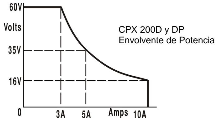
La envolvente de potencia está configurada para proporcionar 60 V / 3 A, 35 V / 5 A y 16 V / 10 A bajo todas las condiciones de alimentación (con carga en ambas salidas); a tensiones de salida menores, la potencia de salida queda restringida por el máximo de corriente de 10 A.
