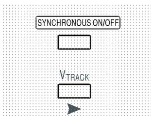
La pulsación de  $V_{TRACK}$  habilita el modo de seguimiento de tensión. Las dos salidas permanecen aisladas eléctricamente pero los controles de tensión de la salida 1 (la maestra) establecen una tensión idéntica en la salida 2 (la esclava). Los controles de corriente de ambas continúan independientes.
