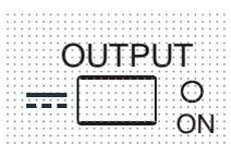
En el encendido, según la configuración de fábrica por defecto, la salida se encuentra desactivada. La tensión y corriente preconfiguradas vendrán determinadas por la configuración de control actual, mostrándose en la pantalla. El piloto VIEW (vista) se ilumina para indicar que los valores que se muestran son los que están preconfigurados. Todos los demás valores serán los mismos que al apagar por última vez.
