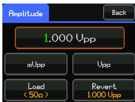
Selezionare il campo modificabile tramite la manopola e premere per attivare lo stato di modifica attiva. Alternativamente, passare immediatamente allo stato di modifica attiva toccando il campo modificabile.
