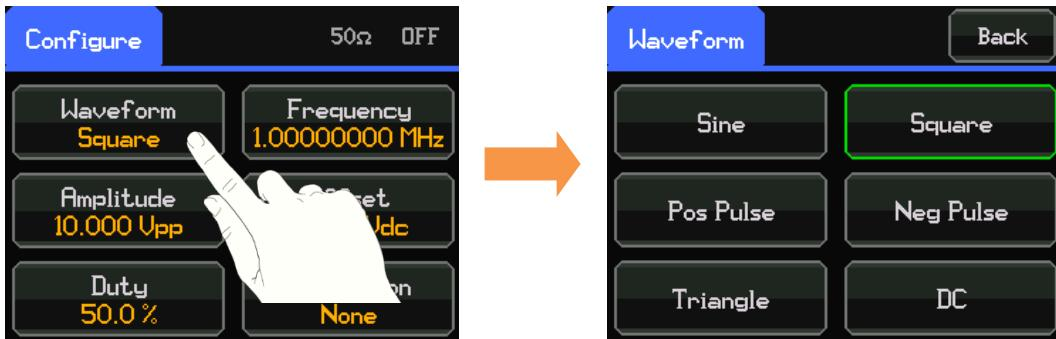
La sélection d'un type de forme d'onde bascule immédiatement sur cette forme d'onde, qui devient alors disponible sur le connecteur MAIN OUT (Sortie principale) si la sortie est activée. Si la sortie n'est pas activée, appuyer sur la touche OUTPUT (Sortie) pour l'activer.
