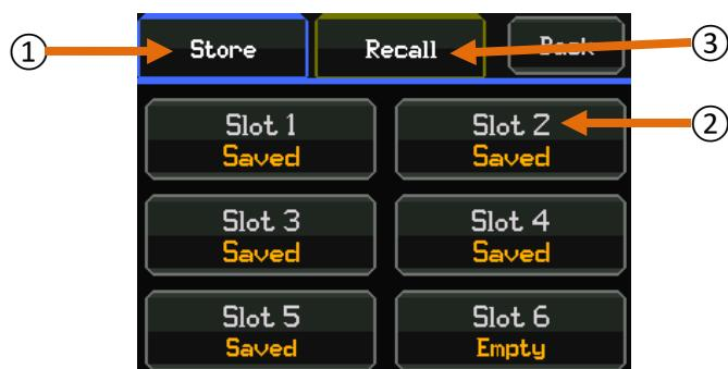
6 emplacements de mémoire sont fournis. Ceux-ci permettent à l'utilisateur de sauvegarder et de rappeler les paramètres de l'instrument.
