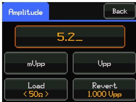
En la pantalla de edición, los dígitos pueden introducirse directamente desde el teclado en la escala que resulte más conveniente. Por ejemplo, aunque es posible introducir 12,34 kHz directamente en kHz, también puede introducirse como 12340 Hz o 0,01234 MHz. Pulse los botones de entrada de unidades Hz o kHz para establecer las unidades y confirmar la entrada.
