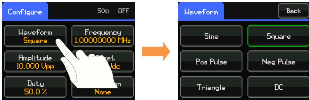
Al seleccionar un tipo de forma de onda, el instrumento comenzará a generarla inmediatamente a través del conector MAIN OUT si la salida estuviera encendida; si no lo estuviera, pulse la tecla OUTPUT para encenderla.
